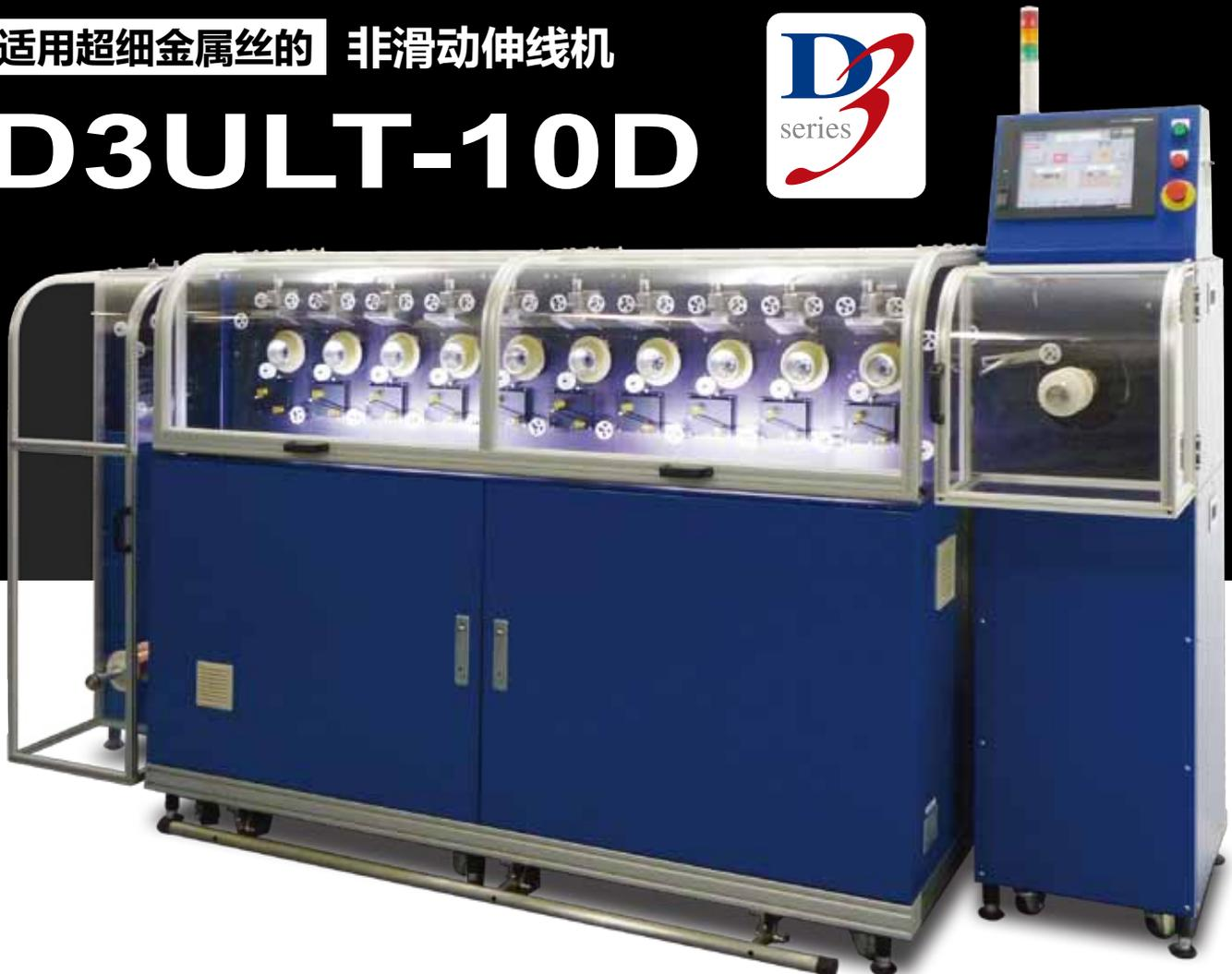
本机器是为了在 $30\mu\text{m}$ 以下超细金属丝领域开创新的伸线技术而研制开发的。把1个张力浮动杆·1个眼模·1个牵引轮作为一个单元，每台机器由复数个这样的单元构成。同时使用独自开发的控制系统直接控制牵引轮驱动，实现了非滑动伸线。将传统技术（滑动伸线）难以实现的超细金属丝伸线变成现实。
